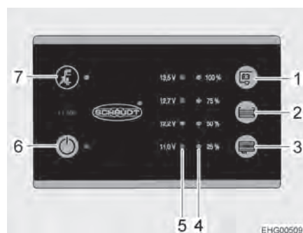
Fig. 101 Pannello di controllo (LT 100)
