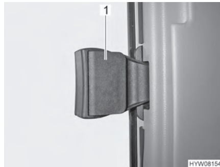
Fig. 37 Finestra scorrevole senza bloccaggio
