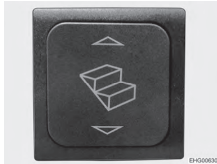
Fig. 4 Interruttore di comando scalino di ingresso
