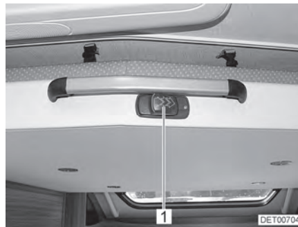
Fig. 75 Letto basculante con bloccaggio
