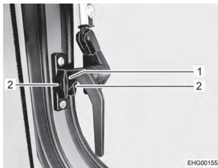
Fig. 43 Leva di serraggio, laterale (posizione "Aerazione continua")
