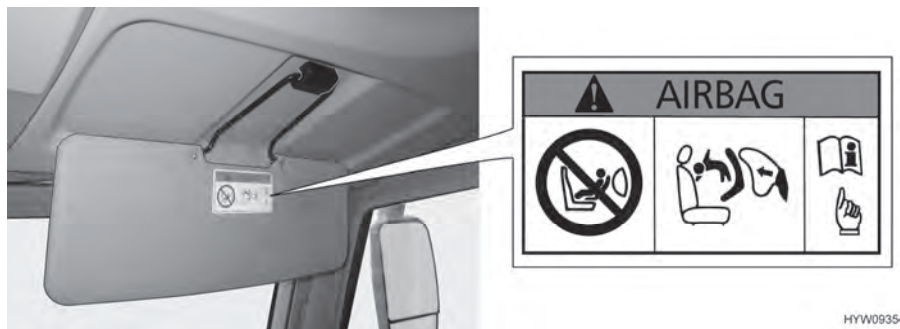
Kuva 13 Lasten turvalaitteisiin liittyvä varoitus (apuohjaajan häikäisysuoja)
