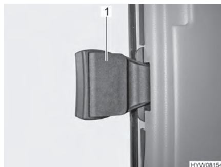
Kuva 37 Liukuikkuna ilman lukitusta
